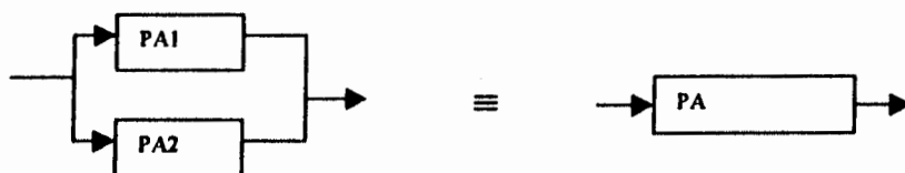
Fig. 3: Ækvivalens mellem to aktiviteter PA1 og PA2, der skal udføres 'parallelt' og en enkelt aktivitet PA.
